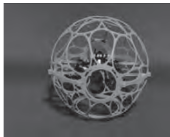
令和8年度顕彰作品 免震階のドローン点検システム
