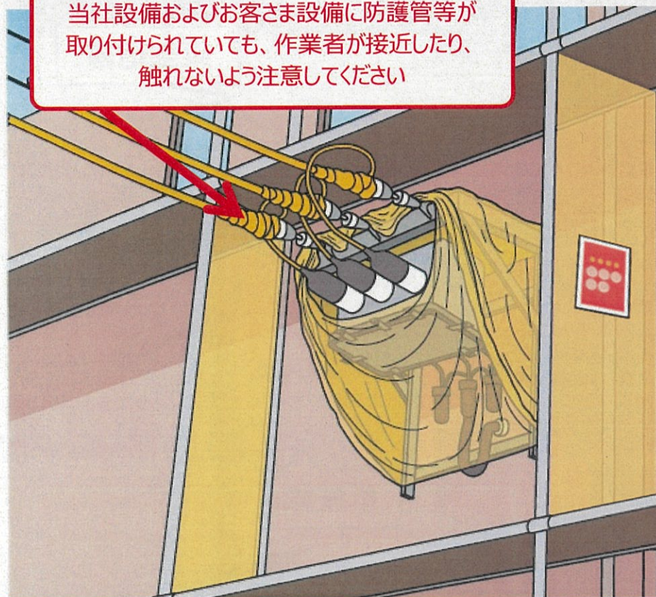
足場上で作業者が接触するおそれがある事例
